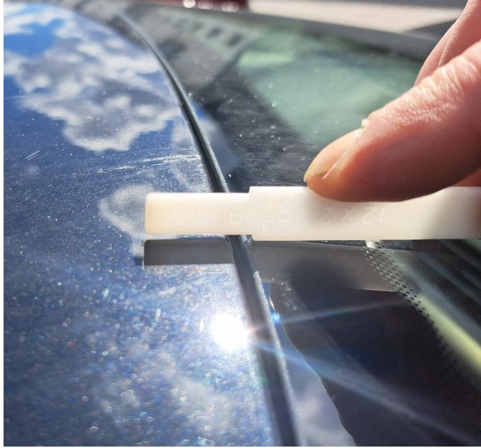
Kuvassa tuulilasinsovituksen asennussyvyys
