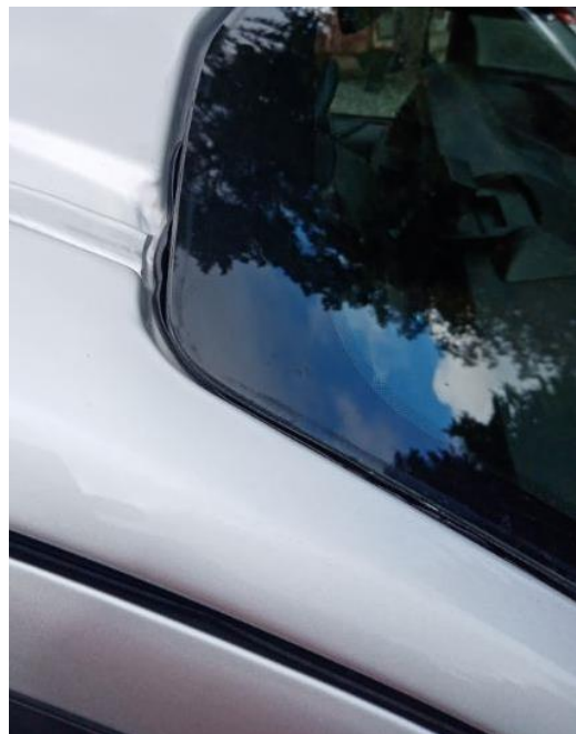
Kuvassa liimapalko pursuaa näkyville tuulilasinvaihdon jälkeen
