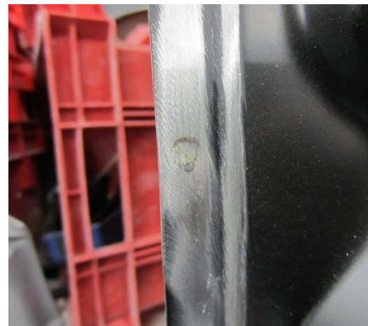
Vastushitsaus → hitsauselektrodien muoto epäsymmetrinen riittämätön hitsausvirta → ei riittävää liitoksenlujuutta
