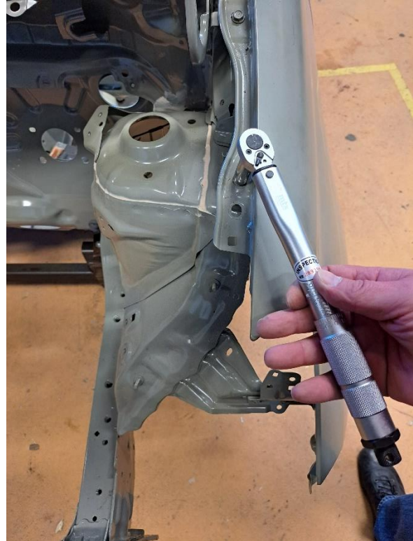
Kuvassa etulokasuojan pulttien kiristys momenttiavaimella
