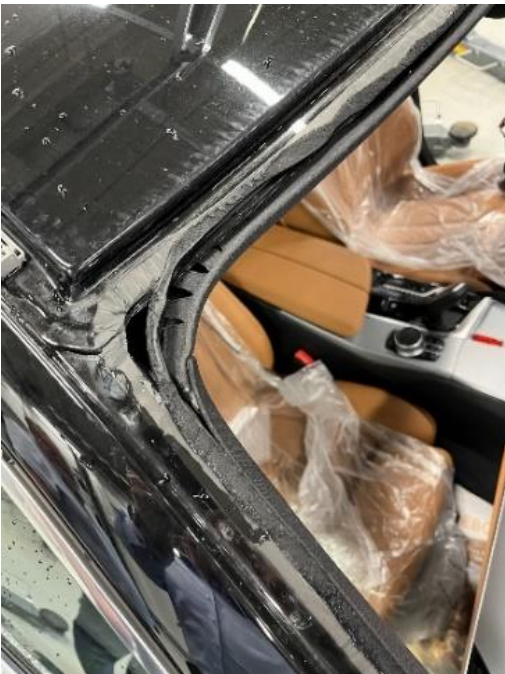
Kuvassa liimapalko väärässä kohtaa tuulilasinvaihdon jälkeen
